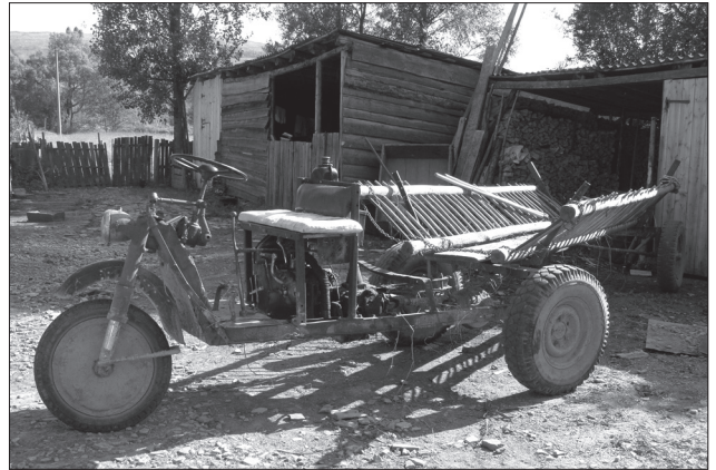
Іл. 12. Дига з мотоциклетним двигуном («інвалідка»), триколісна, з «драбинами» для транспортування сіна
