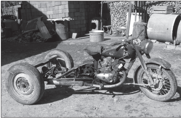
Іл. 5. Дига з мотоциклетним двигуном (ИЖ-49), триколісна, без кузова. Майстер Федір Цюро, 1928 р. н.
