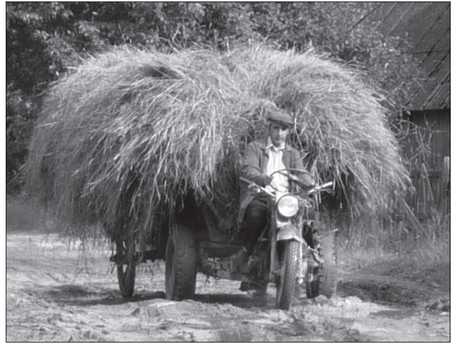
Іл. 10. Дига з мотоциклетним двигуном («інвалідка»), триколісна, з напівпричепом («телігою»)
