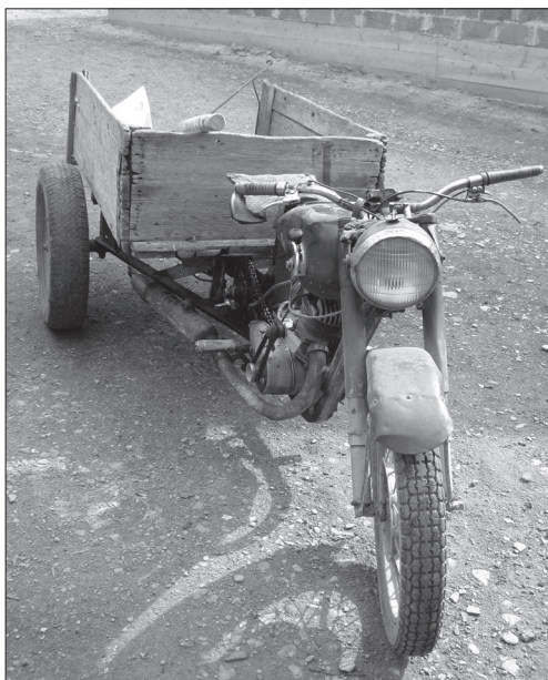
Іл. 6. Дига з мотоциклетним двигуном (ИЖ-49), триколісна, з кузовом. Майстер Федір Цюро, 1928 р. н.
