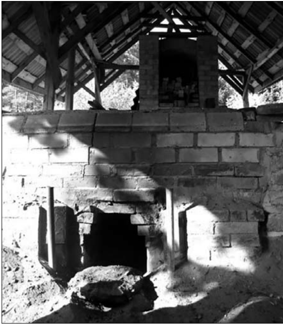
Іл. 18. Округле горно до випалу димленої кераміки, власність Алгімантаса Казлаускаса, Лішкява, Литва. 2016 р. Фото Алгімантаса Казлаускаса
